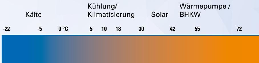
Der Wechsel eines Stoffes von einem in den anderen Aggregatzustand (z. B. von fest zu flüssig) vollzieht sich nur unter Einsatz enormer Energiemengen. Diese werden bei dem umgekehrten Vorgang auch wieder frei. Dieses physikalische Phänomen macht man sich bei den Latentspeichern zu Nutze.
